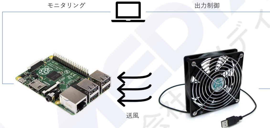
制御ボードの温度を測り、熱ければ冷まし、熱くないなら何もしない。
